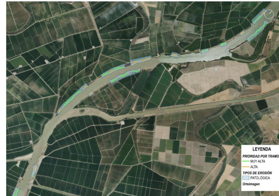
Figura 2. Zonas por tipo de erosión en el tramo Boca Sur Isleta-Olivillos-Corta de los Jerónimos. Fuente: Elaboración propia, 2022
