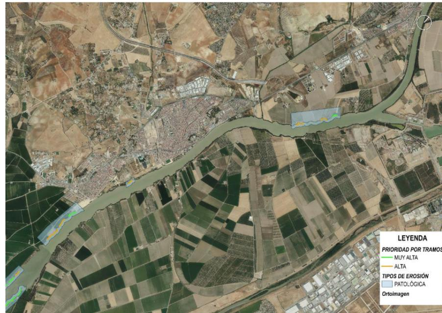
Figura 1. Zonas por tipo de erosión en el tramo Ant esclusa-Huertas-Coria del Río. Fuente: Elaboración propia, 2022
