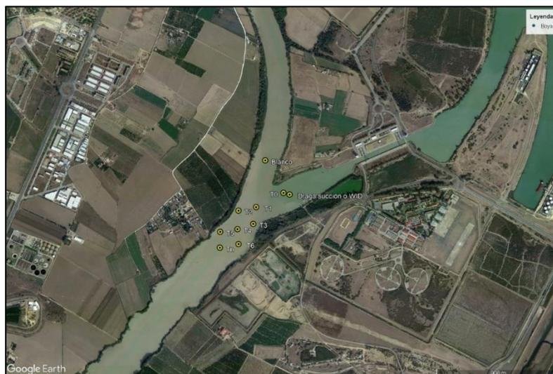
**Ilustración 5. Diseño de malla de muestreo para el control de la pluma de turbidez en dragado. Fuente: Elaboración propia, 2022.**
