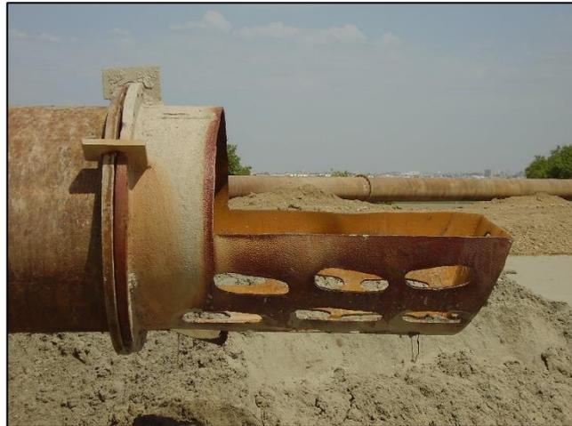
**Ilustración 9. Filtro de retención de materiales colocado en la boca de salida de la tubería.**
