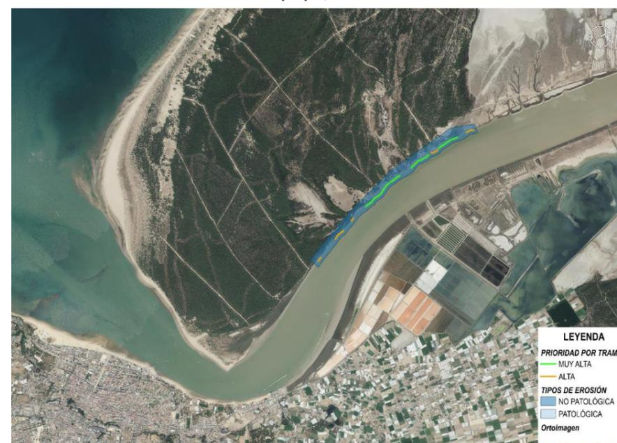
Figura 8. Zonas por tipo de erosión en el tramo Salinas – Broa. Fuente: Elaboración propia, 2022
