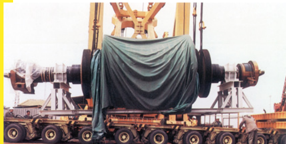
Descarga de un rotor de la turbina con destino a la central nuclear de Valdecaballeros | 1983 | Fototeca del Archivo de la Autoridad Portuaria de Sevilla
