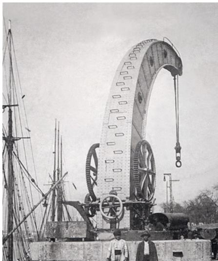
Grúa fija de 40 toneladas Fairbairn de Manchester trasladada desde las inmediaciones del puente de Triana tras la construcción del muelle de Nueva York | Ca. 1905 | Fototeca del Archivo de la Autoridad Portuaria de Sevilla, fondo Sánchez del Pando, Serrano y otros
